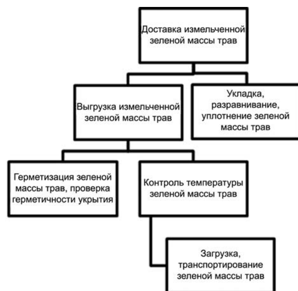
Рис. 2. Схема технологического процесса приготовления и хранения силоса и сенажа
