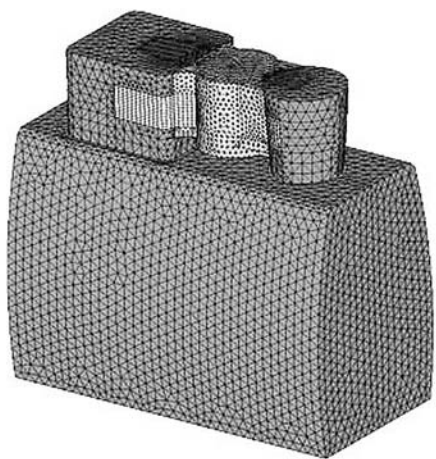
Рис. 2. Конечно-элементная модель АВК
